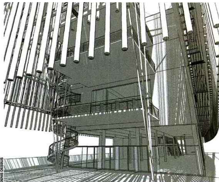
Conçu par Denis Dessus, le pavillon Rhône-Alpes (3 000 m 2 sur 4 niveaux, coût : 5 millions), se veut un modèle d'écoconstruction : bambou en façade...
