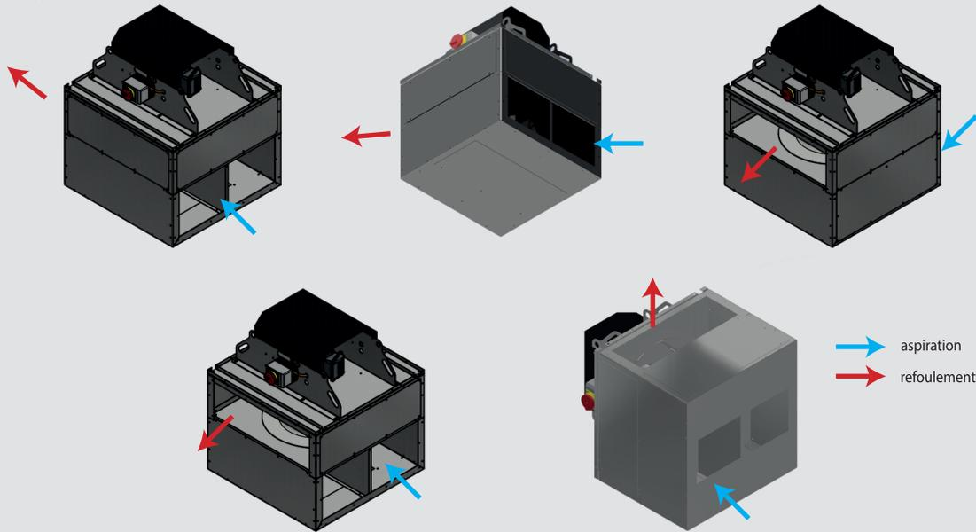
Seules les installations présentées sont conformes. Le montage axe vertical est autorisé, jusqu'à la taille 9 000.
