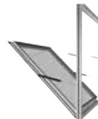
DENFC\* avec abattant extérieur et mécanismes intégrés
