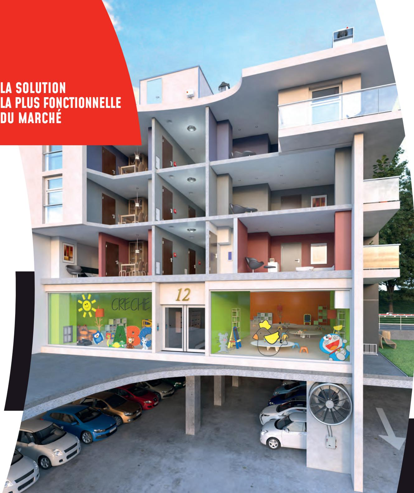
► Les ventilateurs doivent normalement assurer leur fonction avec des fumées à **200 °C pendant 1 h**. L'alimentation électrique des ventilateurs doit être assurée par une dérivation issue **directement du tableau principal et sélectivement protégée**.
