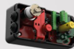
Le raccordement électrique utilise des **connecteurs débrochables** et un **serre-câble anti-traction** pour maintenir les câbles.
